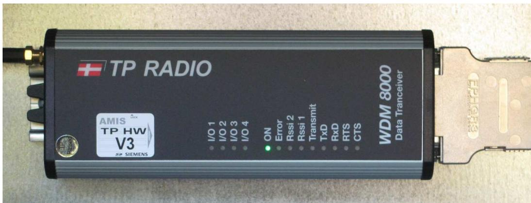
Bild 7: Foto des Funkgerätes in der Trafostation (nicht zu verwechseln mit dem AMIS-Stromzähler). Dient der Weiterleitung der Daten über Funk (70-cm-Band). Siehe dazu auch Bild 6, da ist die zugehörige Antenne zu sehen. Ab hier sind im Normalfall keine Störungen mehr zu erwarten.
